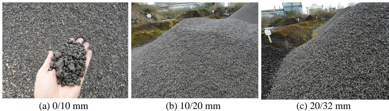
Picture 10 : Ground slag fractions
